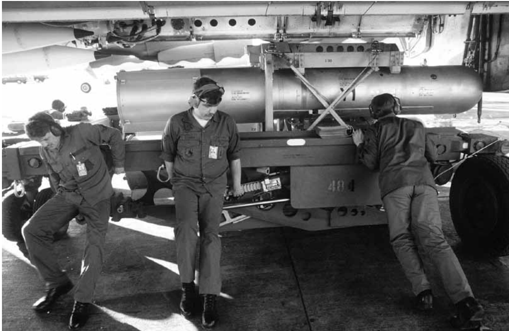
8 skyrius. Aptarnaujantys technikai iškrauna MK-28FI termobranduolinę bombą iš strateginio bombonešio B-52H Elsverto oro pajėgų bazėje, Pietų Dakotoje, 1984 m.
