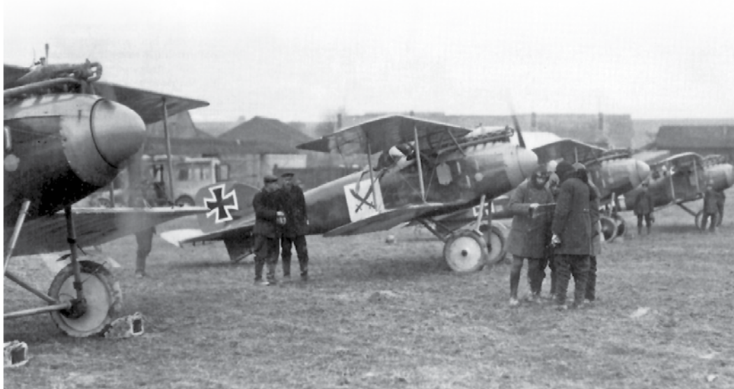
Albatros D.II naikintuvų rikiuotė. Šie lėktuvai pradėti eksploatuoti 1916 m. Maksimalus greitis – 175 km/h, ginkluoti dviem sinchronizuotais kulkosvaidžiais MG 08.
